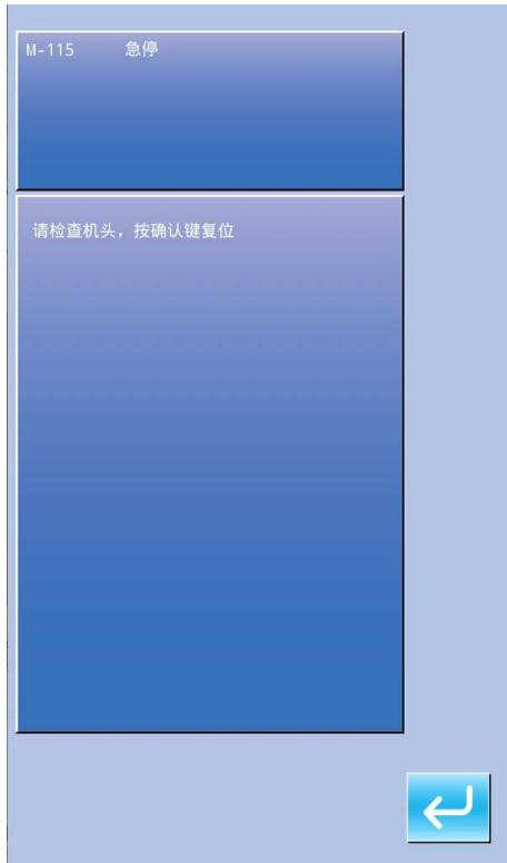
缝制过程中, 按下停止开关后, 缝纫机中断缝制, 停止转动。此时显示界面如图所示:
