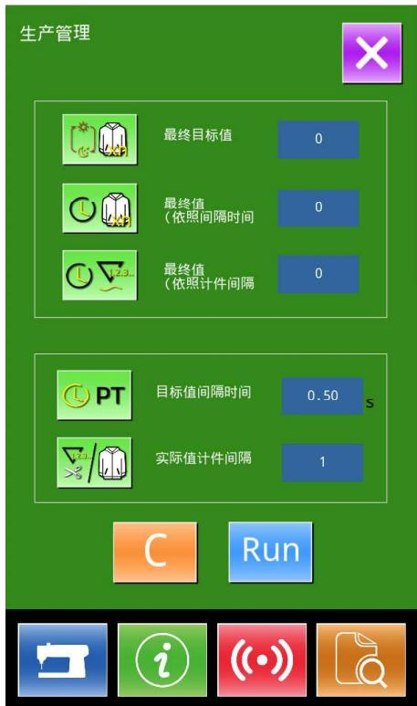
按 **Run** 键之后, 【最终目标值】【目标值】【实际值】变灰, 并开始生产件数的计数。
