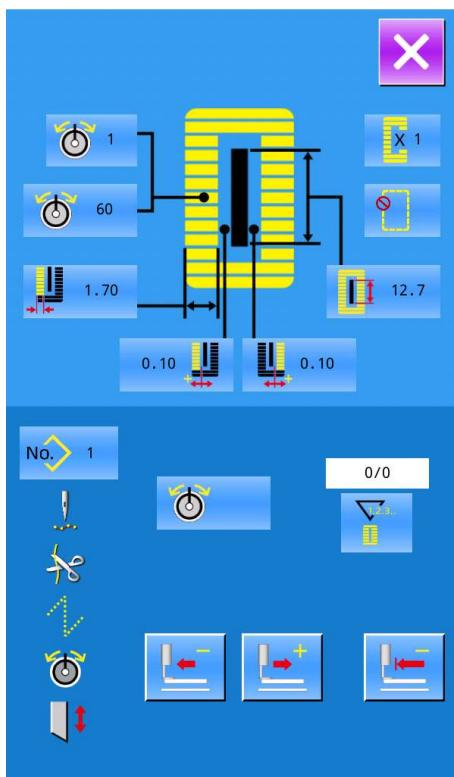
在缝制界面下，按下 键后进入试缝界面(如图所示)：
