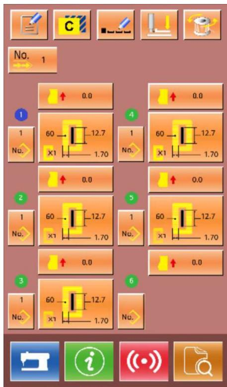
④ 在连续缝主界面下，添加连续缝使用的花样和送布量
