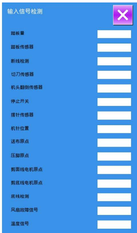
在检测模式界面按下 输入检测键进入输入检测界面(如图所示)，在该界面下可以确认各种开关和传感器的输入状况。
